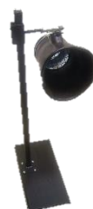
Entonnoir avec cône en caoutchouc BG monté sur pied avec régulation verticale et dispositif d'inclinaison.
